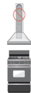
**ЗАПРЕЩЕНО** присоединять воздухоотводящие патрубки вытяжных зонтов от газовых плит в дымоотводящие и вентиляционные каналы
