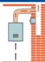
**ЖЕЛЕЗО-СОЕДИНИТЕЛЬНЫЕ ТРУБЫ (ЖСТ) ДЛЯ ОТВОДОВ ПРОДУКТОВ СГОРАНИЯ В ДЫМОХОД**
